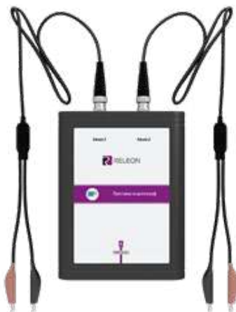
Рис. 1. Двухканальная приставка-осциллограф Releon
